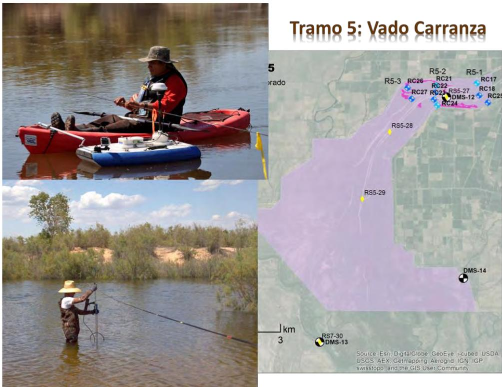
Fig. 4. Imagen de mediciones de aforo de los estudiantes de posgrado del Programa de Maestría y Doctorado en Ciencias e Ingeniería de la UABC.
