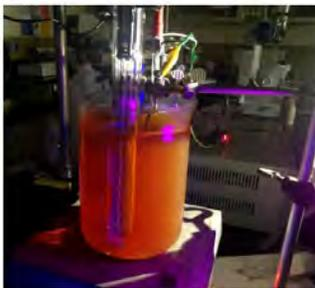
**Aplicación de la electroquímica para la síntesis y preparación de las nanopartículas.**
