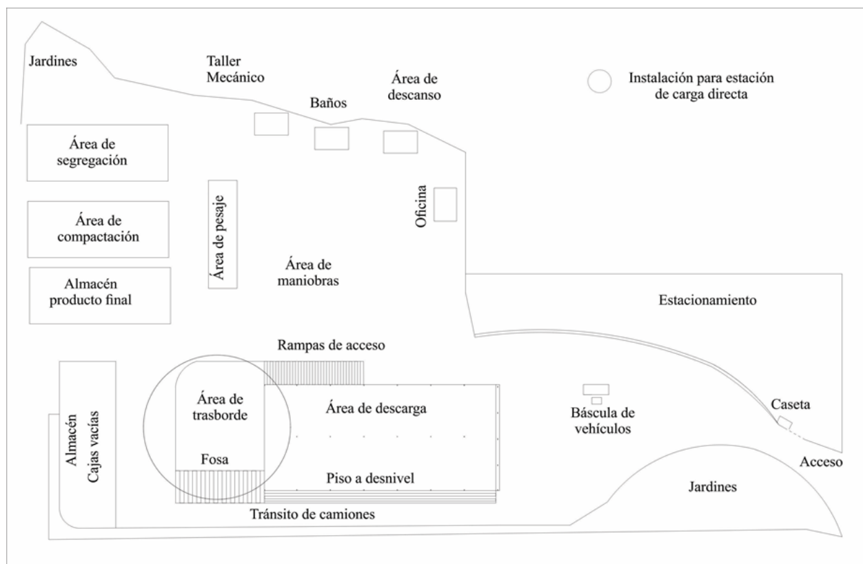
Figura 4. Ubicación de las instalaciones y áreas de operación requeridas en el diseño de una estación de transferencia.
