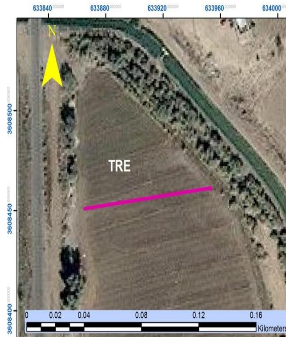
Figura 4. Ubicación de la línea de tomografía resistiva eléctrica en una parcela agrícola en Mexicali, imagen generada en ArcGIS versión 9.
