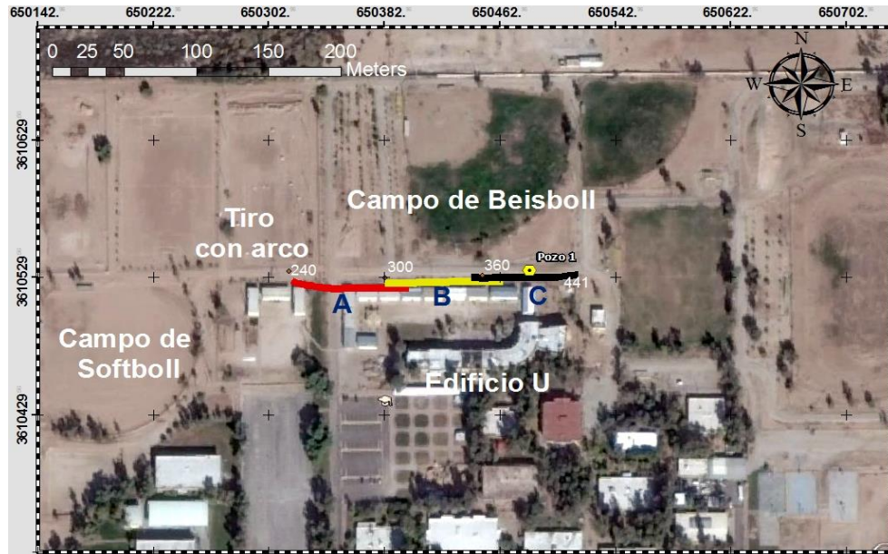
Figura 9. Ubicación de la línea de tomografía eléctrica en los campos del ITM, consta de tres perfiles A, B, C. Mapa generado en ArcGIS versión 9.
