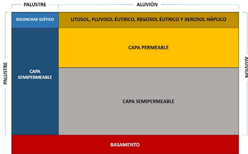
Figura 9. Esquema representativo de las capas verticales del AVM. Vista en perfil.
