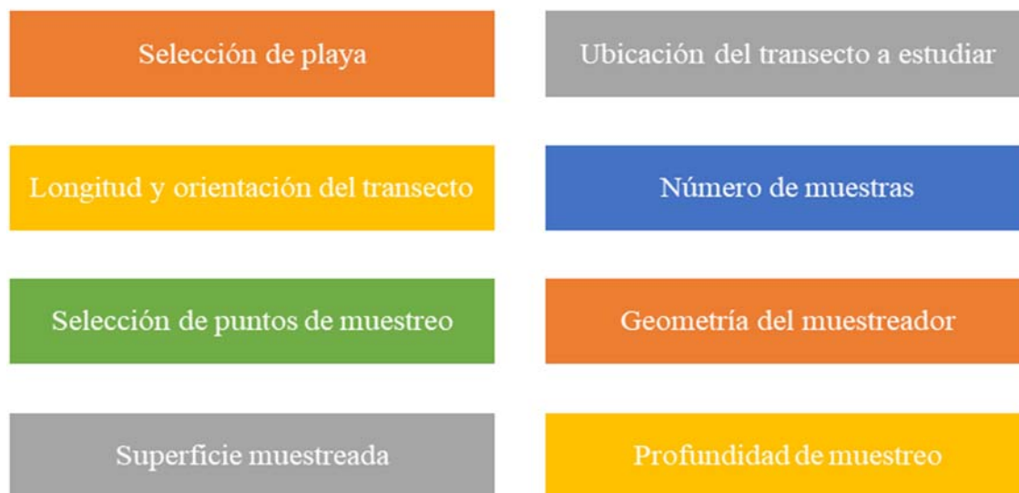
Figura 4. Elementos que deben definirse al realizar un muestreo de microplásticos en playas. Elaboración propia.
