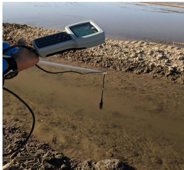
Figura 7. Medición in situ de parámetros fisicoquímicos en agua.
